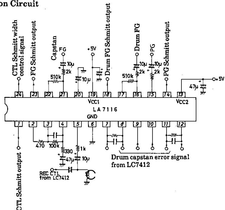
Unit (resistance : Ω, capacitance : F)
