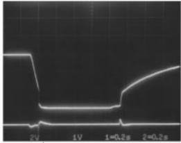
$$\begin{split} &V_{CC}=13.2 \text{ V}, \\ &R_L=4 \ \Omega, \\ &Rg=0, \\ &\text{Mute ON/OFF} \end{split}$$
